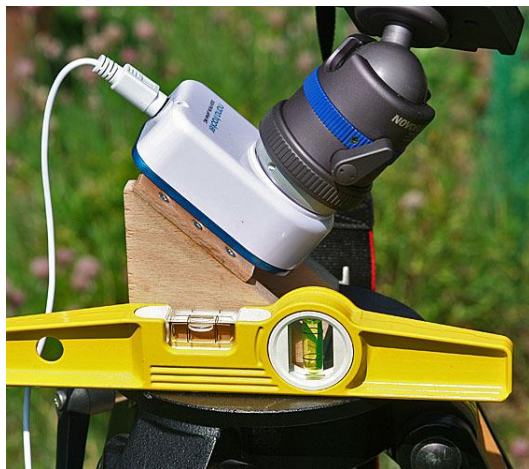
Bild 5 Ausrichten des Stativs mit Hilfe einer Wasserwaage
